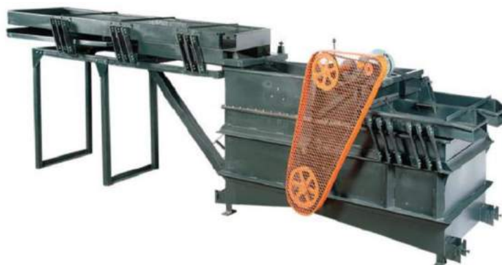
Hình 86: Một loại máy rửa và phân loại quả tươi chế tạo trong nước
