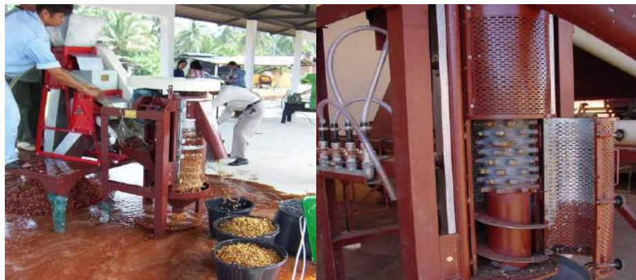
Hình 96: Đánh nhót cơ học và cấu tạo máy đánh nhót trực đứng
