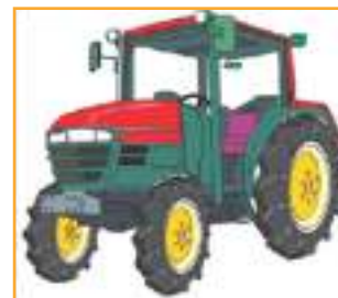
Máy cày, máy kéo cần có cấu trúc bảo vệ chống lật
