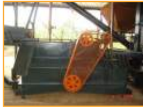
Che chắn bộ phận truyền động của máy chế biến
